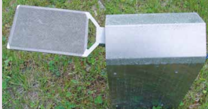
Fot. 7. Wagowy system sterowania zamgławianiem (tzw. elektroniczny liść)
